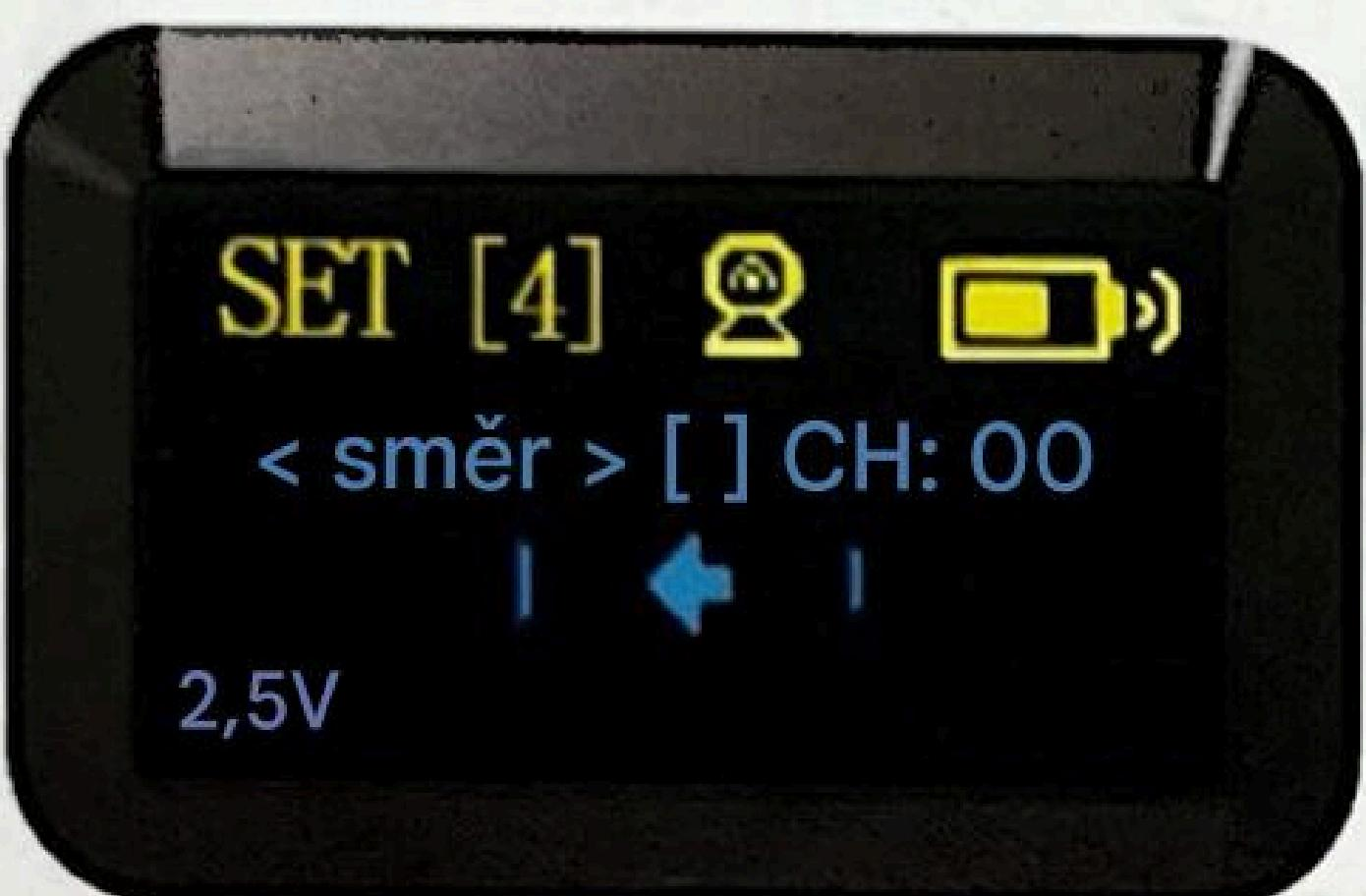
Stiskněte znovu "S" pro vstup do dalšího kroku, "Direction" pro nastavení směru otáčení. Dalším stisknutím "S" uložíte a zobrazíte "[ok]" pro návrat do výchozího rozhraní. Stisknutím Start/Pauza spustíte aktuální režim.
