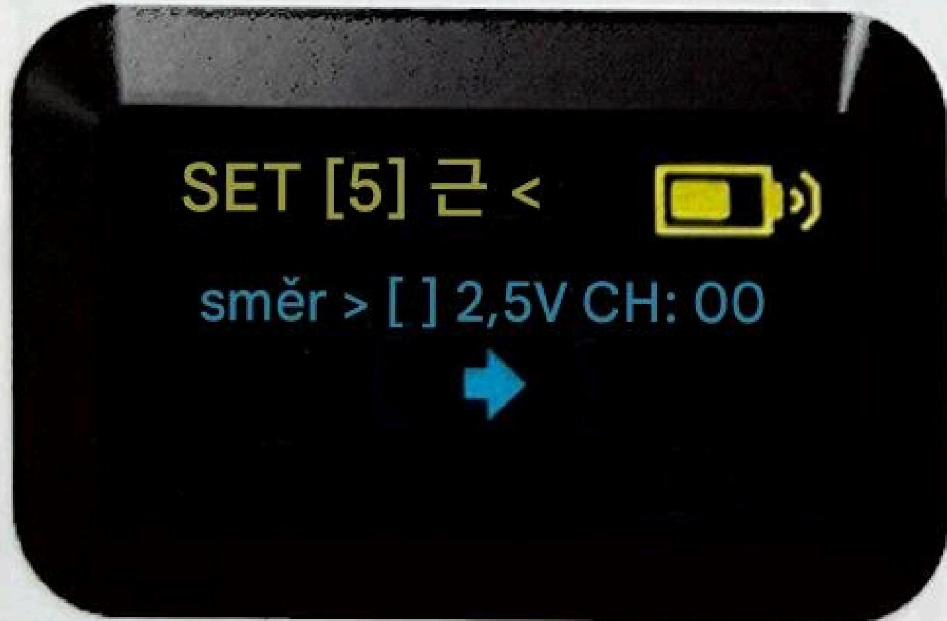
Opětovným stisknutím "S" nastavíte směr otáčení. Dalším stisknutím "S" uložíte a zobrazíte "[ok]" pro návrat do výchozího rozhraní.
